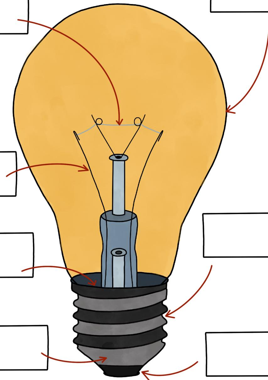
Glaskolben Glühdraht Fußkontakt Gewinde
